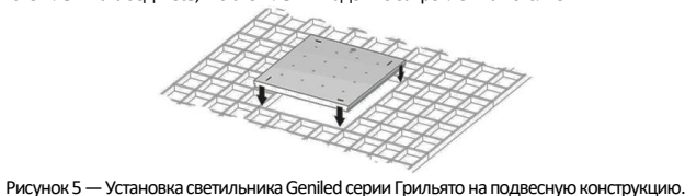
Рисунок 5 — Установка светильника Geniled серии Грильято на подвесную конструкцию.
